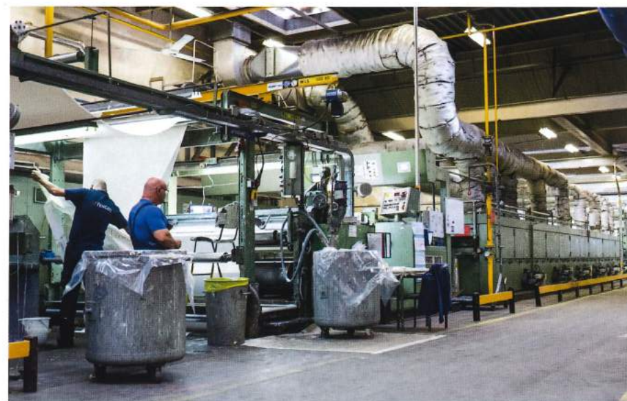
✦ In deze enorme machine wordt het doek gecoat, gefixeerd en voorzien van een finish
